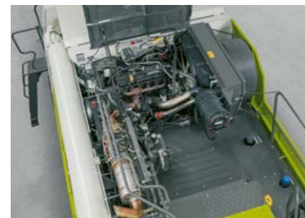
Motor Cummins con tratamiento posterior de los gases de escape con AdBlue (Stage V)
