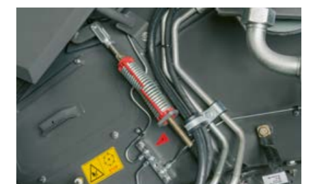
Todos los puntos de lubricación están recopilados en barras centrales de lubricación y tienen una señalización clara.
