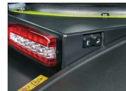
El elevador trasero puede manejarlo externamente en los dos guardabarros traseros
