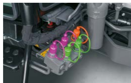
Delante están disponibles hasta cuatro conexiones hidráulicas, así como un retorno libre.
