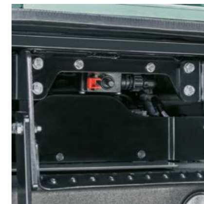
El interruptor de desconexión de la batería está colocado a mano en la entrada izquierda.
