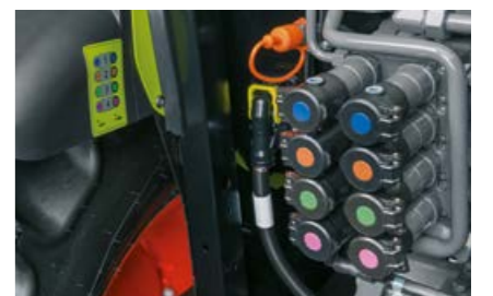
Las conexiones en la parte trasera se reconocen fácilmente por su codificación de colores y los adhesivos colocados al lado.
