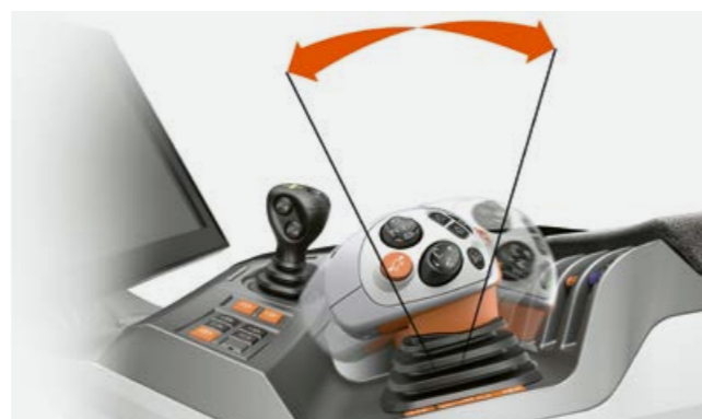
Manejo progresivo con la tecnología de la caja de cambios continua CMATIC.
