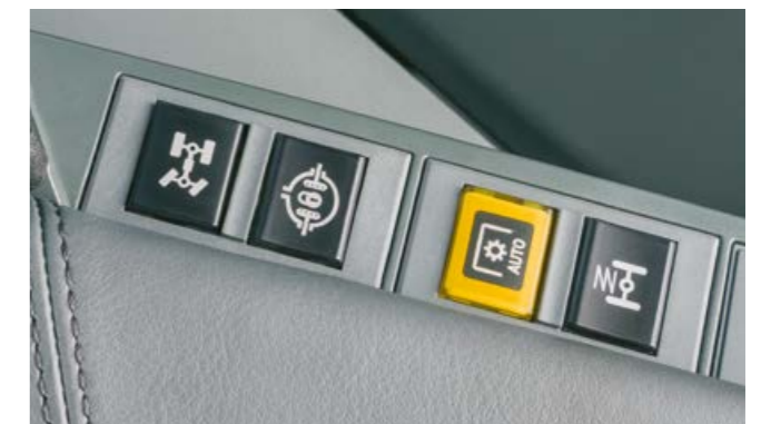
Activación de la suspensión del eje delantero.
